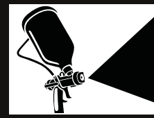
Aplicar COREVSTONE DIAMANTE con equipo de alta presión, en varias capas de forma circular y sin saturar
